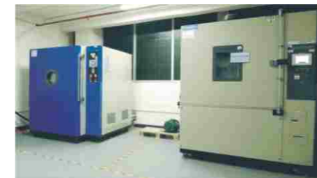
Камера испытаний на воздействие низкого давления (слева) Камера испытаний на продолжительное воздействие температур и влажности (справа)
