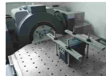
Система вибрационных испытаний электромагнитным возбудителем
